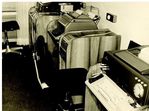
Slika 12. Teleprinterska soba v Zbirnem centru, kjer so sprejemali in oddajali črkovno-številčne podatke.
