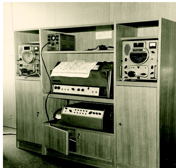
Slika 13. Sprejemni radiofaksimilni sistem Ladoga (spodaj) in sprejete karte (zgoraj)
