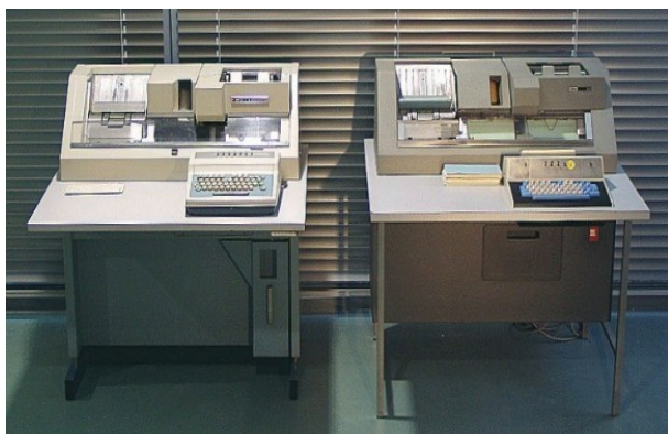
Slika 16. Luknjači, ki smo jih uporabljali za luknjanje kartic, kot vhodni pripomoček v računalnik.
