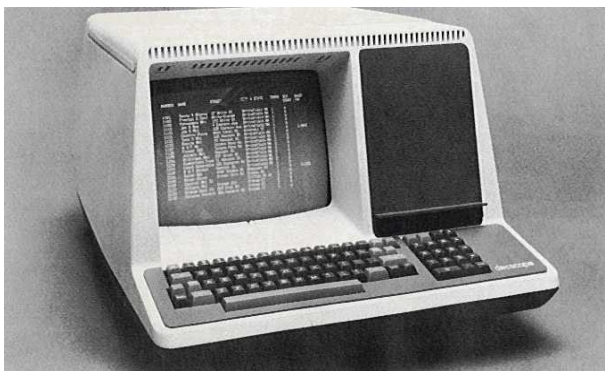
Slika 18. Videoterminal VT 52, povezan s centralno enoto z 20 mA zanko in prenosnim protokolom RS232/V24
